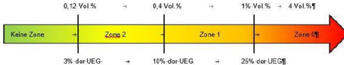
Abbildung 7 – Zoneneinteilung anhand der Wasserstoffkonzentrationen
